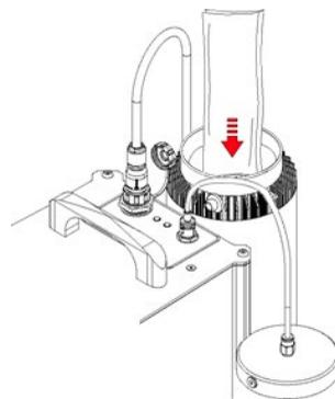
5. Fermer le couvercle du réacteur (12) en vissant dans le sens horaire jusqu'à la butée. Il est recommandé de refermer rapidement le réacteur avant le début de la réaction pour éviter les projections d'eau.
