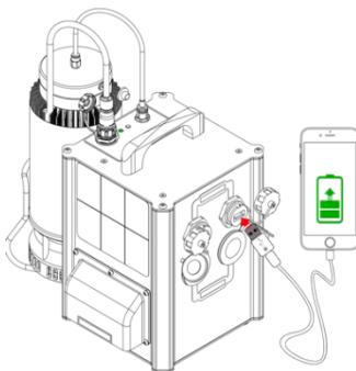
4- En cas de surconsommation électrique (puissance électrique demandée excédant la production d'hydrogène dans le réacteur), le générateur coupe les sorties électriques USB ou allume-cigare en fonction de la puissance mesurée sur les prises et le voyant rouge s'allume en continu. Il est nécessaire de débrancher l'équipement provoquant une surconsommation pour que le générateur continue de fonctionner.
