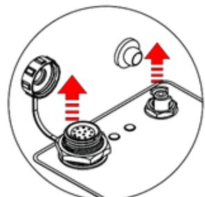
2. 水素供給コネクター⑭の何も付いていない方を水素発生器の蓋⑫の中央にあるソケットに差し込みます。ソケットに差し込むだけで接続します。（外す際には黒いリングを押しながらコネクターに過度な力が加わらないよう引つ張ってください。）
