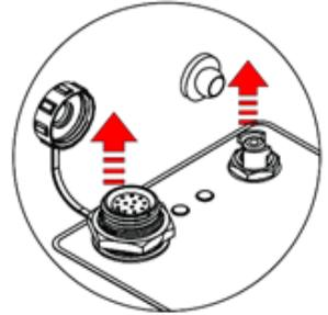
2. 水素供給コネクタ⑭の何も付いていない方を水素発生器の蓋⑫の中央にあるソケットに差し込みます。ソケットに差し込むだけで接続します。(外す際には黒いリングを押しながらコネクタに過度な力が加わらないように引っ張ってください。)
